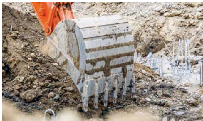
Nástroje Hitachi GET mají samoostřící zuby a spolehlivé adaptéry pro zajištění přesného lícování součástí.
