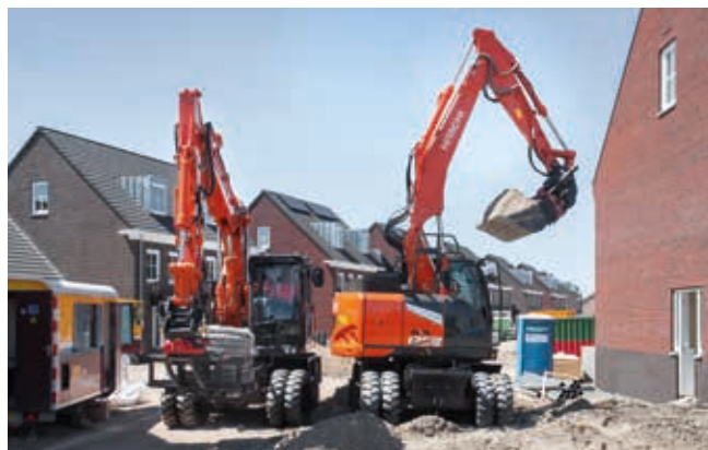
Model ZX135W-7 se otáčí v poloměru 3,5 metru (1 740 mm dozadu a 1 750 mm dopředu).
