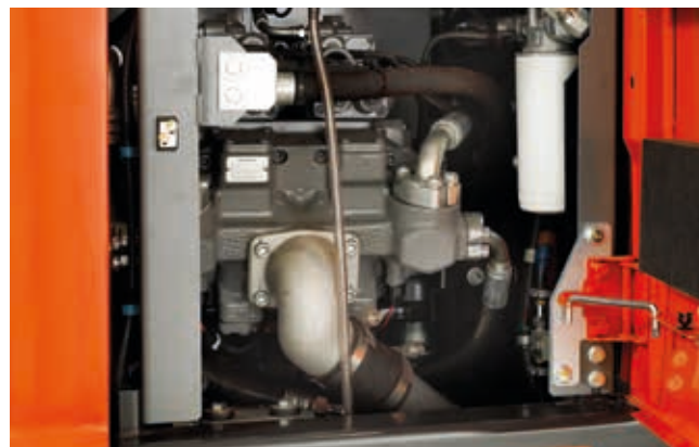
Úspora paliva až 5 % je dosažena díky hydraulickému systému HIOS V (ZX150W-7 a ZX155W-7).
