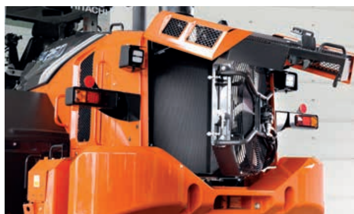
Inteligentní systém ovládání ventilátoru zabráňuje ucpávání chladiče motoru.
