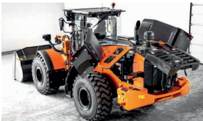
Kryt motoru umožňuje pohodlný přístup při provádění denních prohlídek.
