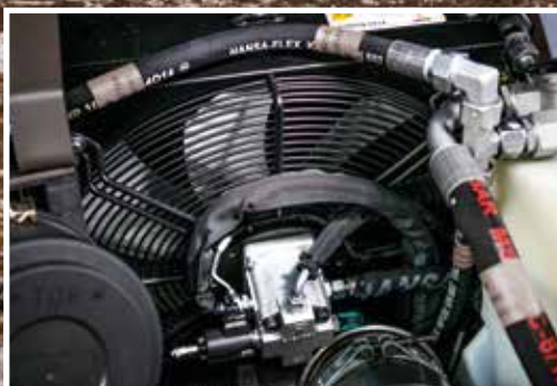
Motorový ventilátor pomáhá snižovat emise a zlepšovat účinnost využití paliva.
