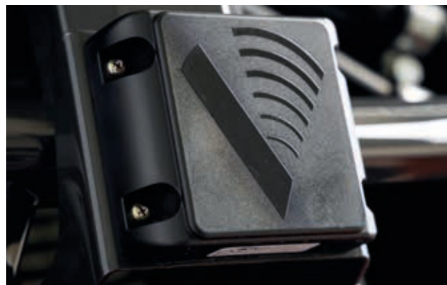
Systém detekce překážek za vozidlem zvyšuje bezpečnost na pracovišti.
